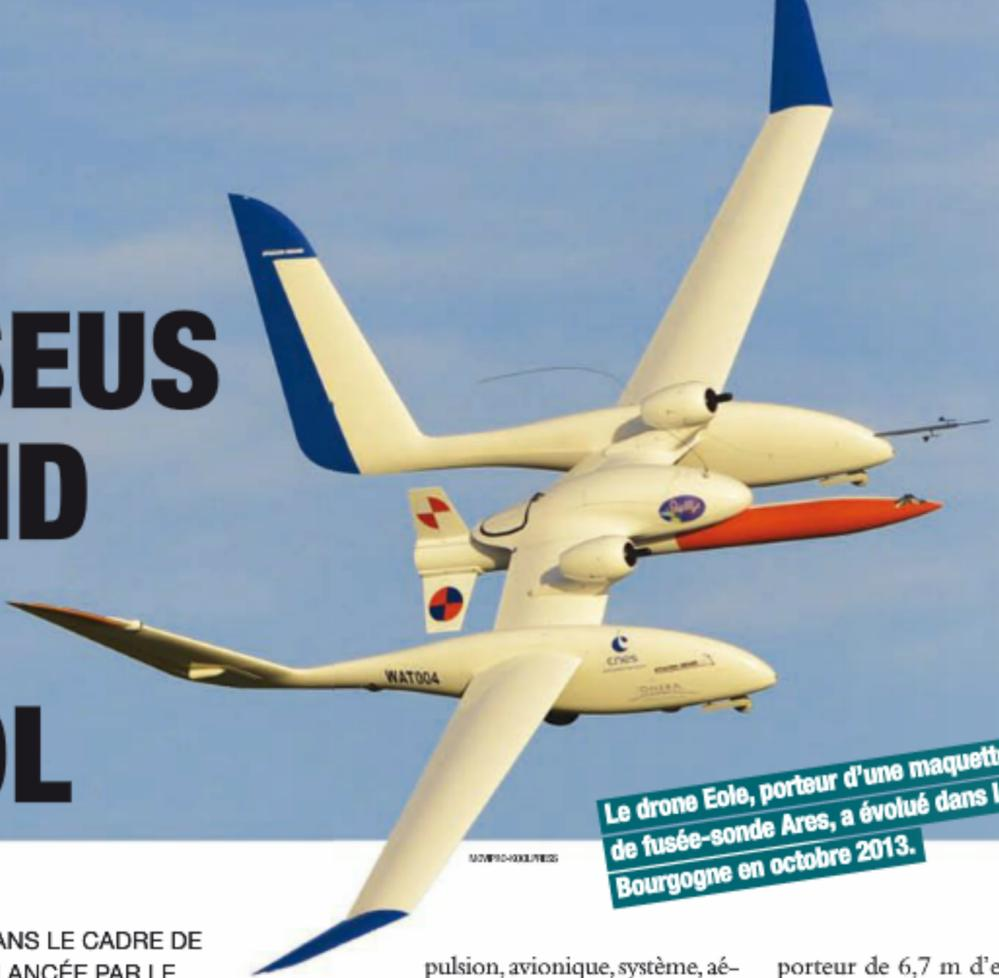
Le drone Eole, porteur d'une maquette inerte de fusée-sonde Ares, a évolué dans le ciel de Bourgogne en octobre 2013.
